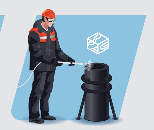
8. Зачисти верхний торец электродной свечи деревянным бруском! Продуй торец и ниппельное гнездо сжатым воздухом.
