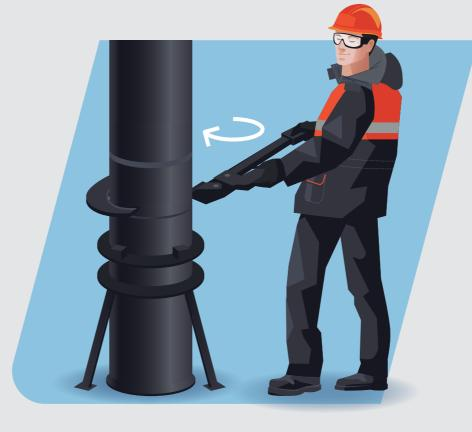
11. Свинчивай электроды с помощью специальных станков для свинчивания. Применяй динамометрические ключи. Обеспечь необходимое усилие свинчивания согласно Таблице 1:
